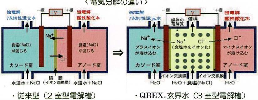
従来型の電解槽に中間槽を設けることにより電気分解に必要な塩分をほとんどカット
